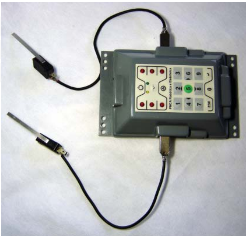
Sensores de contato instalados no MC2.
