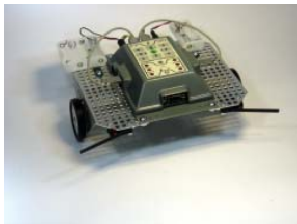
Sensores de contato instalados no robô ZERO.
